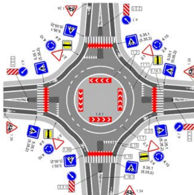
б) Приклад схеми ОДР на розв'язці кільцевого типу за наявності велосипедного переїзду та пішохідного переходу (колову частину кільцевої розв'язки може бути позначено розміткою 1.7 або 1.7 та 1.1)
