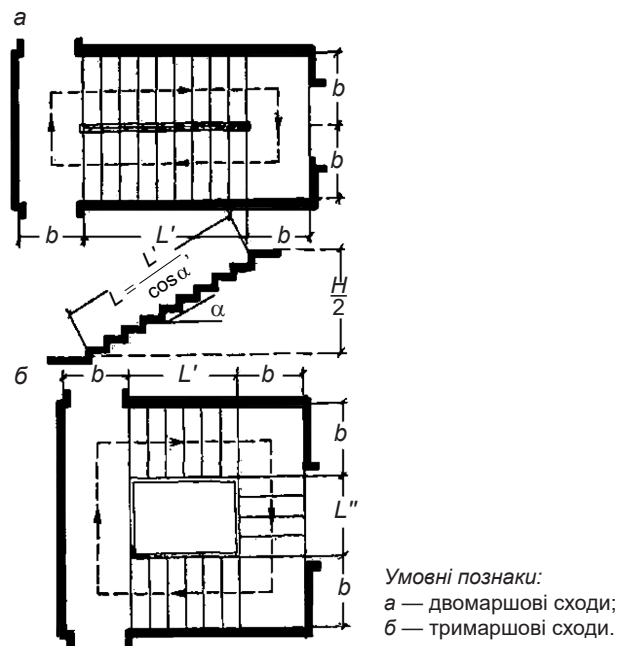
Рисунок А.5 — Розрахункова довжина шляху сходами
