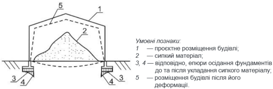
Рисунок 7.7.7 — Деформації в разі перевантаження підлоги складської будівлі сипкими матеріалами за рахунок зміщення елементів, осідання фундаментів та підлог
