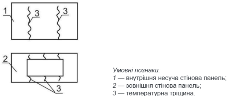
Рисунок В.6.12 — Температурні тріщини через температурно-вологісні деформації
