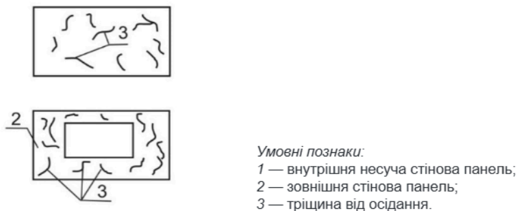
Рисунок В.6.11 — Тріщини від осідання через деформації від осідання бетону
