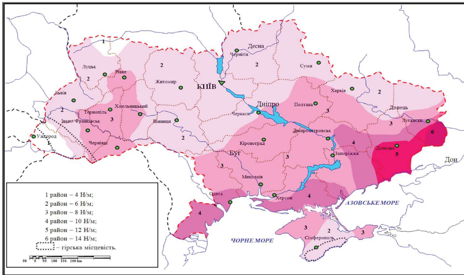
Рисунок 2.5.5– Карта районування території України за характеристичним навантаженням дії вітру на проводи та троси діаметром 10 мм, вкриті ожеледдю
